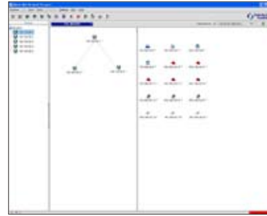
トポロジビュー ルータ間、スイッチ、デバイス間の接続設定および表示を行うためのGUI
